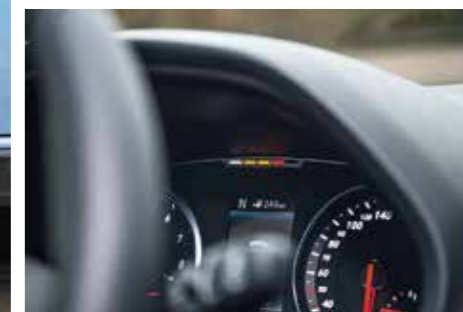
Po vzoru formulí a ostrých závodáků se při vysokých otáčkách začnou rozsvěcet v zorném poli řídicí diody.
