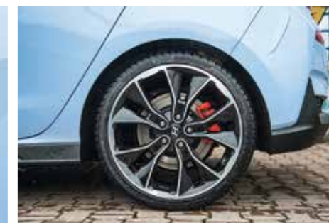
Také zadní brzdy jsou ventilované a mají na sportovní hatchback nadstandardní průměr 315 mm.
