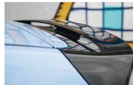
Zadní křídlo optimalizuje proudění ve vysokých rychlostech, vzhled vozu zůstává příjemně decentní.
